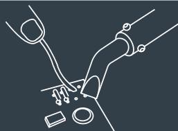
4. Caliente la superficie a soldar, no la soldadura.
